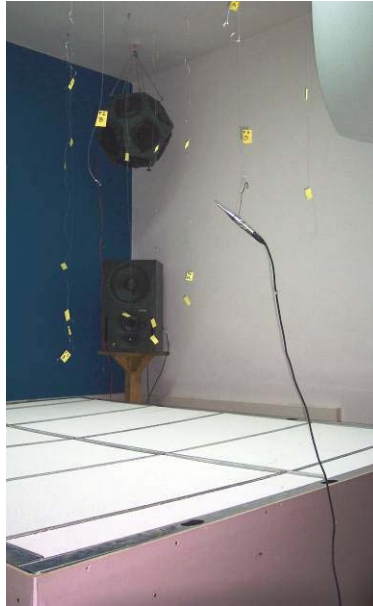
Configuración N o 2 (50% de placa USG RADAR 2410 y 50% de placa Difusora OBetha I)
